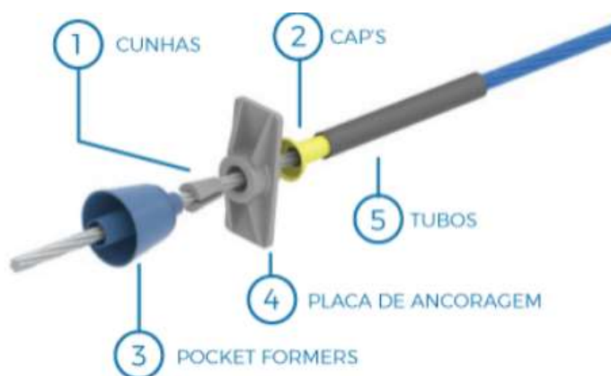
Figura 20 - Cordoalha engraxada e componentes para protensão não aderente.
