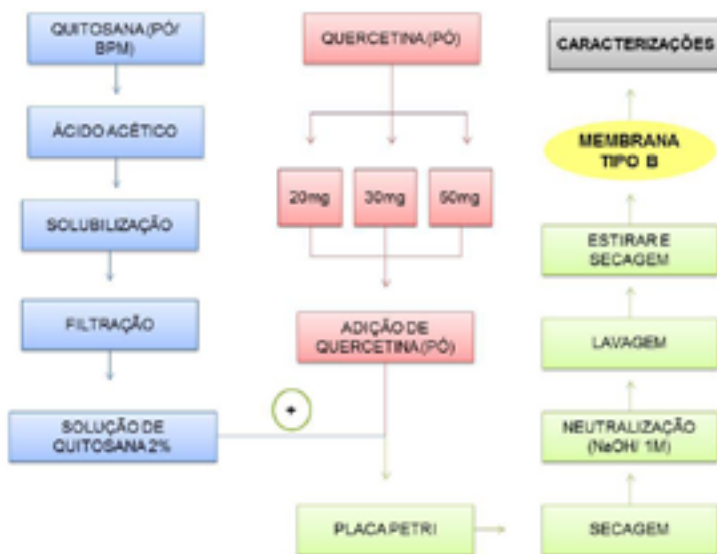
Figura 30 - Fluxograma seguido para obtenção das membranas de quitosana/ quercetina tipo B. Fonte: Pesquisa direta (2013).
