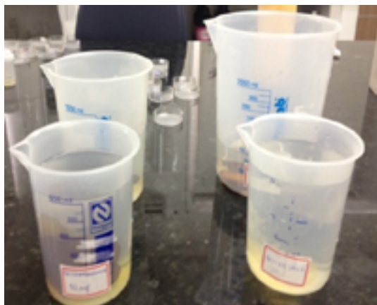
Figura 28 - Lavagem das membranas do tipo B após neutralização com NaOH.
