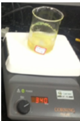
Figura 31 - Processo de agitação magnética da solução e evaporação do metanol.
