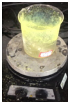
Figura 31 - Processo de agitação magnética da solução e evaporação do metanol.
