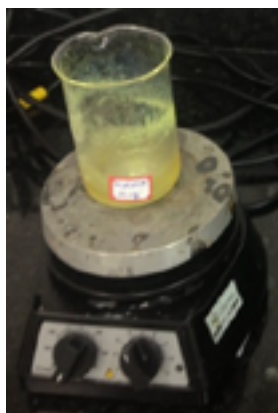
Figura 31 - Processo de agitação magnética da solução e evaporação do metanol.
