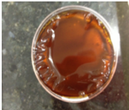
Figura 27 - Processo de neutralização com NaOH das membranas do tipo B.
