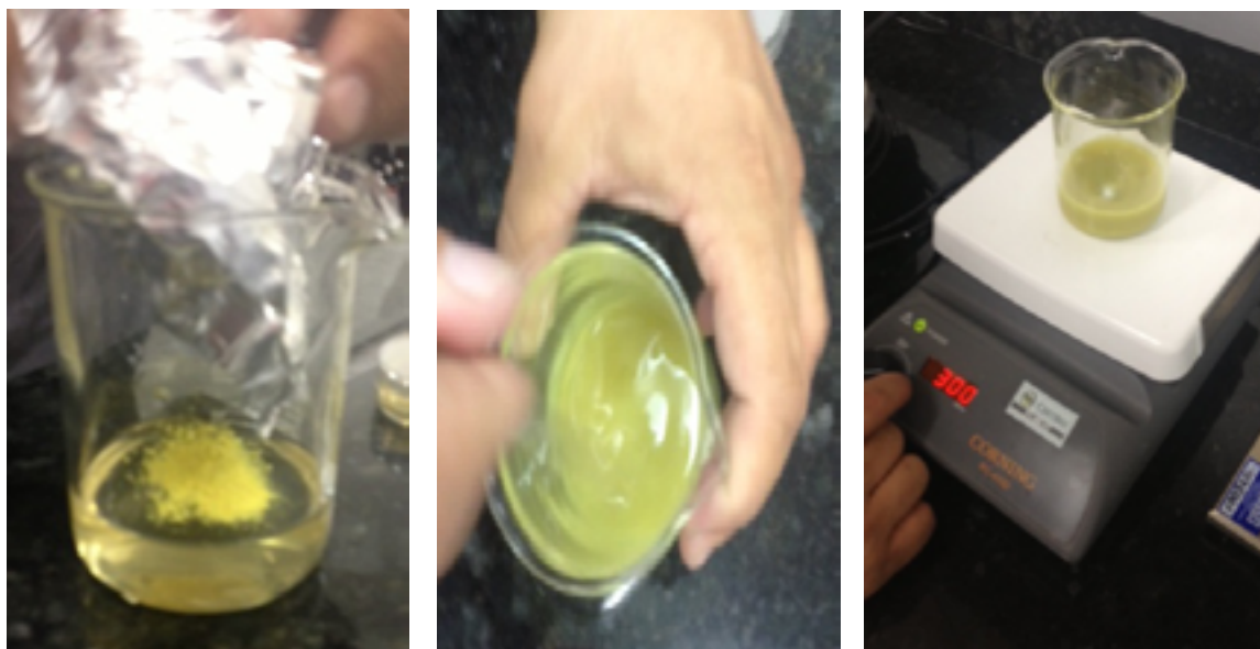
Figura 23 - Adição da quercetina na solução de quitosana neutralizada, seguida da agitação magnética.
