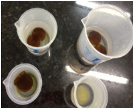
Figura 28 - Lavagem das membranas do tipo B após neutralização com NaOH.
