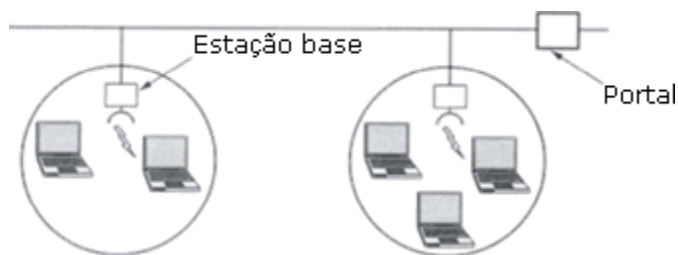
Figura 7 - Dispositivos de Uma Rede WLAN. Fonte: Kurose e Ross (2010).
