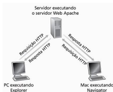
Figura 4 - Modelo Requisição/Resposta do Protocolo HTTP. Fonte: Kurose e Ross (2010).
