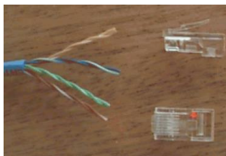
Figura 3 - Cabo de par trançado. Fonte: Redes: Guia Completo (3ª ed.).
