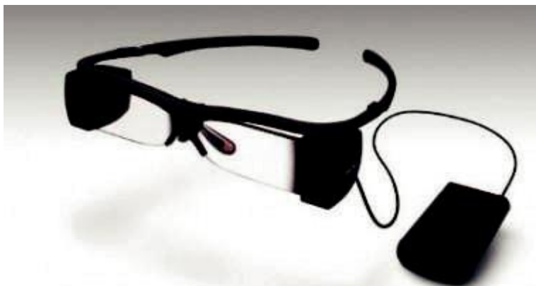
Figura 12 - Óculos legenda para surdos Fonte: http://www.pontosdevista.com.pt/index.php?option=com_content&view=article&id=3585:oculos-inovadores-com-legendas-para-surdos&catid=65:tecnologia-internacional&Itemid=98 .em 17/01/2013
