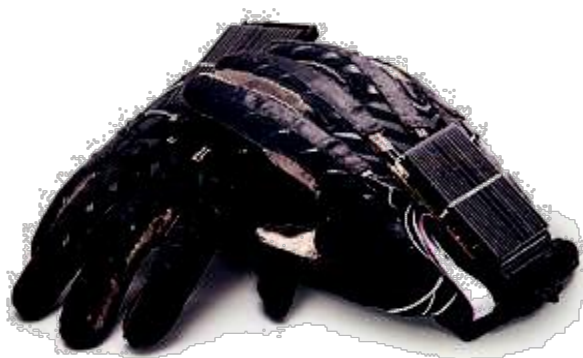
Figura 13 - Luva que converte Libras em som Fonte: http://vidamaislivre.com.br/noticias/noticia.php?id=5888&%2Fluva_converte_libras_em_som_para_facilita_r_comunicacao . Em 02/02/2012.
