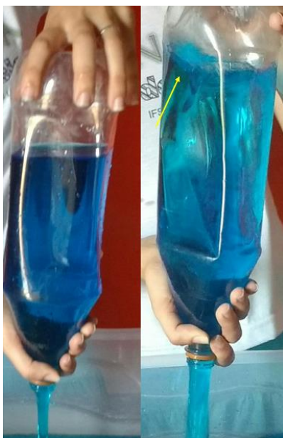
Figura 4.8: Mostra duas garrafas PET uma com um orifício de (2,80 \pm 0,05) mm na parte inferior do litro e outra intacta.
