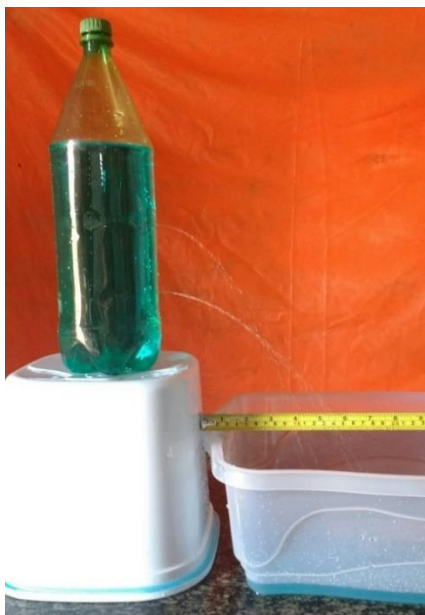
Figura 4.7c: Aparato experimental da garrafa PET com dois orifícios de (2,80 \pm 0,05) mm alinhados na vertical.
