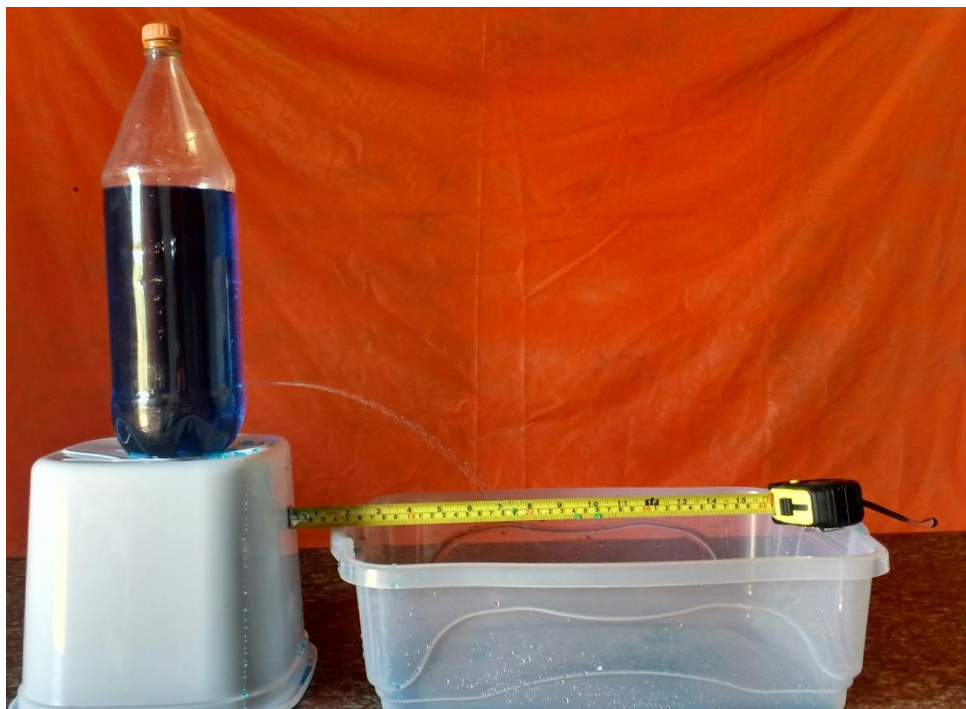
Figura 4.5b: Mostra o aparato experimental com uma garrafa PET sem rosqueada que contei um orifício de (2,80 \pm 0,05) mm na parte inferior.
