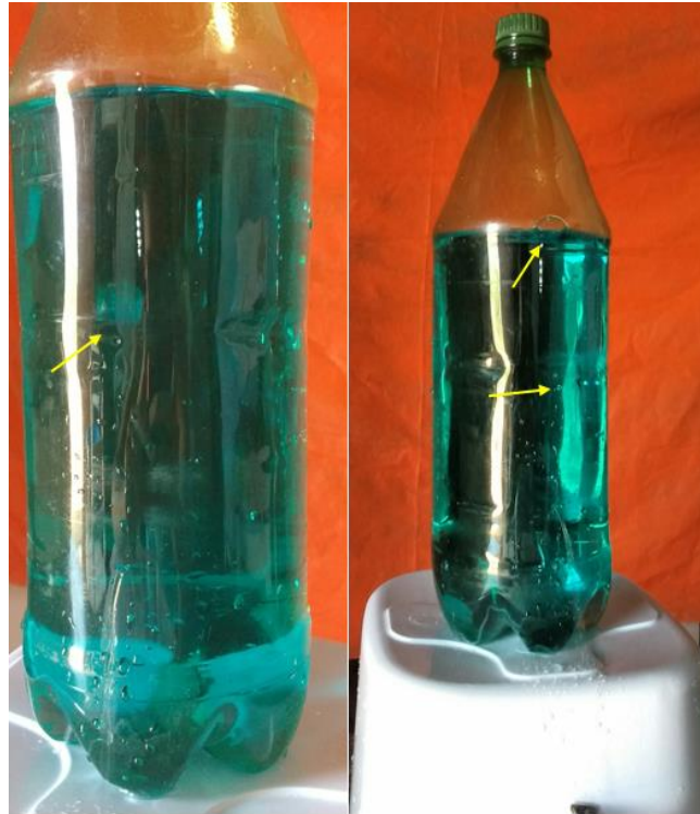
Figura 4.7a: Aparato experimental da garrafa PET com dois orifícios de (2,80 \pm 0,05) mm alinhados na vertical.
