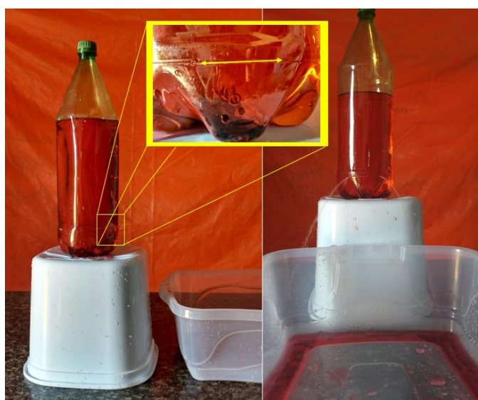
Figura 4.6: Aparato experimental da garrafa PET com dois orifícios de (2,80 \pm 0,05) mm alinhados na horizontal podem ser observados através da seta na imagem.
