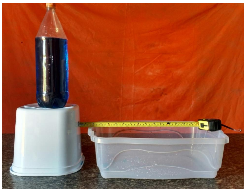
Figura 4.5a: Mostra o aparato experimental com uma garrafa PET rosqueada que contei um orifício de (2,80 \pm 0,05) mm na parte inferior.
