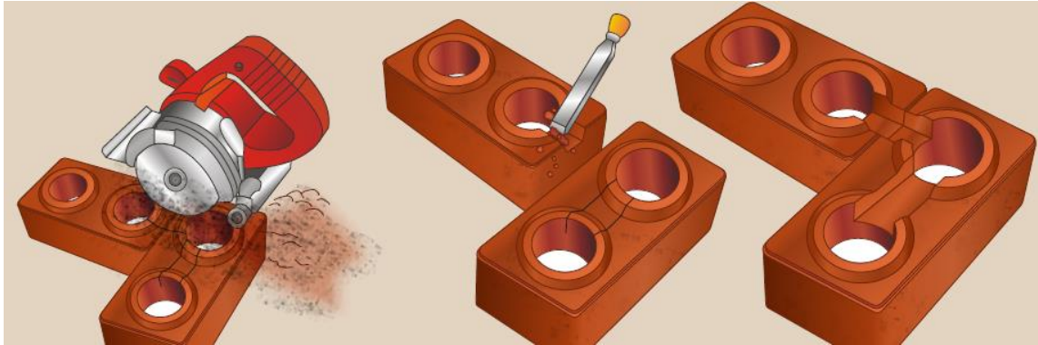
Figura 29 – Criação de sulcos com serra circular manual.
