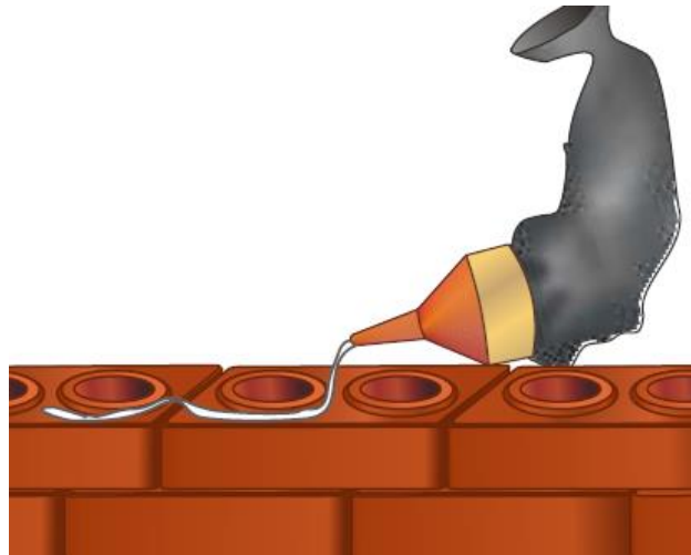
Figura 25 – Aplicação do filete de cola branca ou argamassa com bisnaga.
