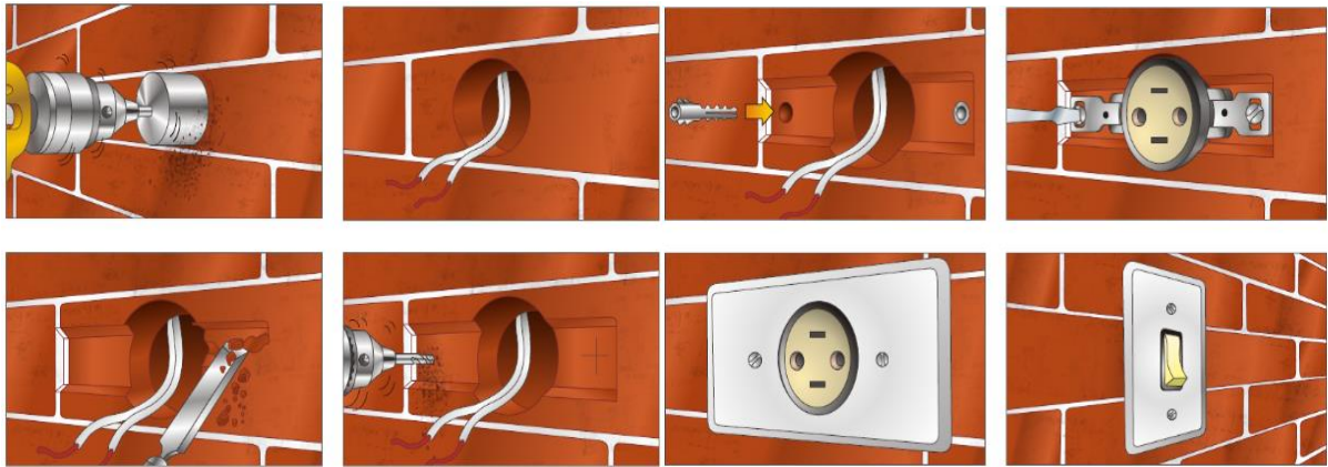
Figura 27 – Execução da instalação elétrica.
