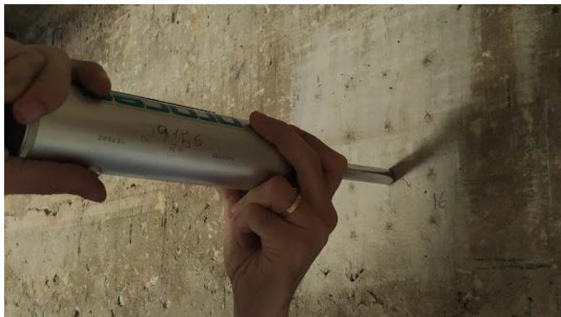
Figura 40 – Realização do ensaio de esclerometria
