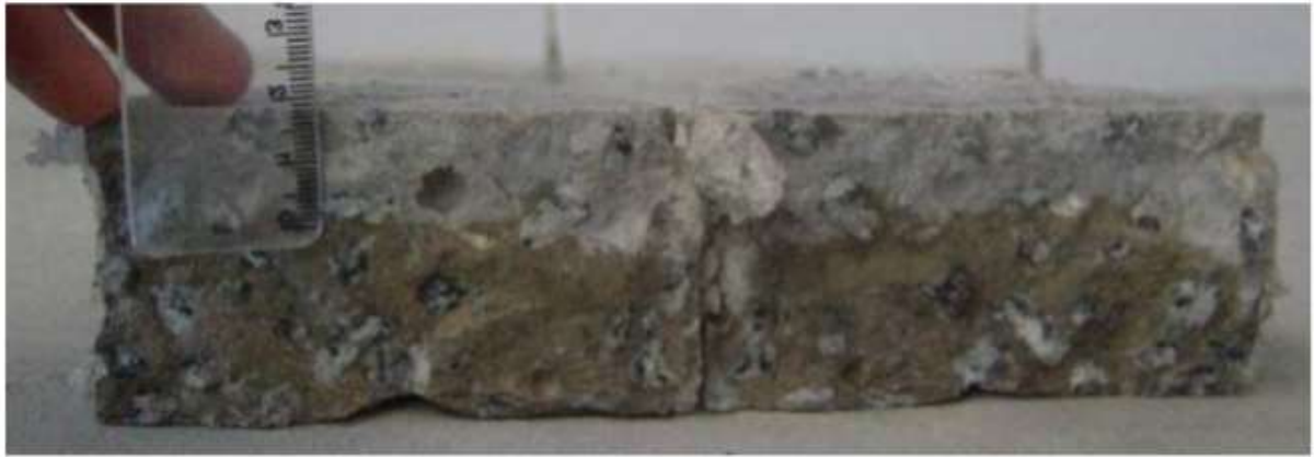
Figura 10 - Camada afetada pelos íons cloretos
