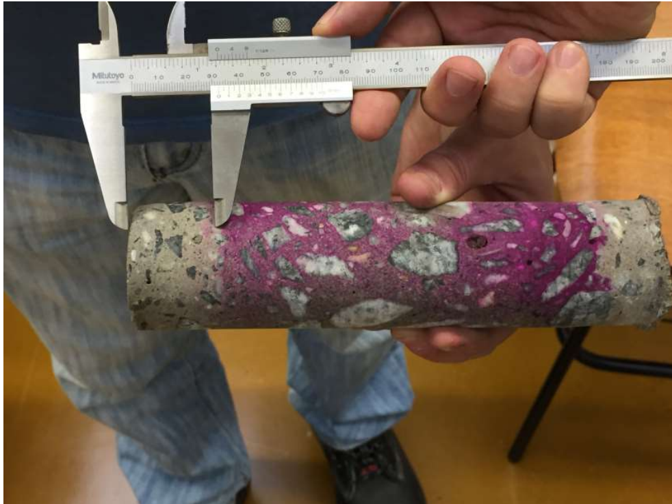
Figura 6 - Medição da camada carbonatada
