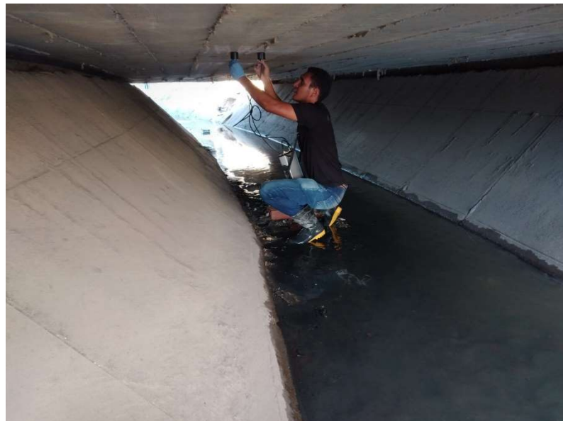
Figura 45 - Realização do ensaio de ultrassonografia
