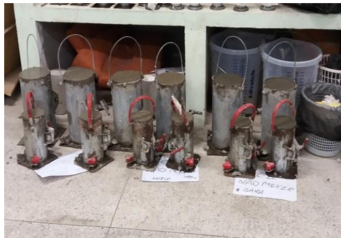
Figura 8 - Moldagem dos corpos de prova
