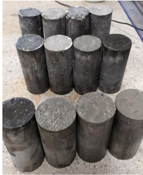
Figura 11 - Corpos de prova (3 traços diferentes)
