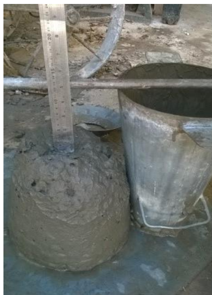
Figura 7 - Abatimento do tronco de cone
