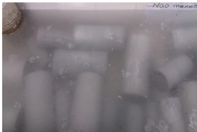
Figura 9 - Cura dos corpos de prova
