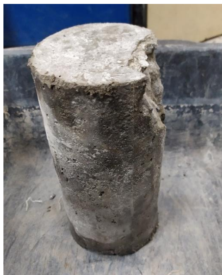
Figura 12 - Rompimento de corpo de prova a compressão
