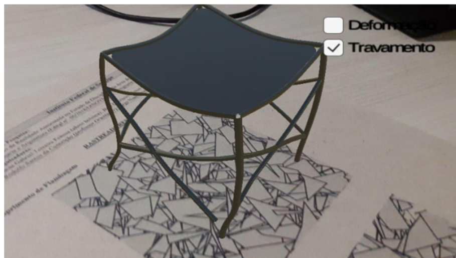
Fotografia 2 – Modelo em Realidade Aumentada para demonstração da flambagem
