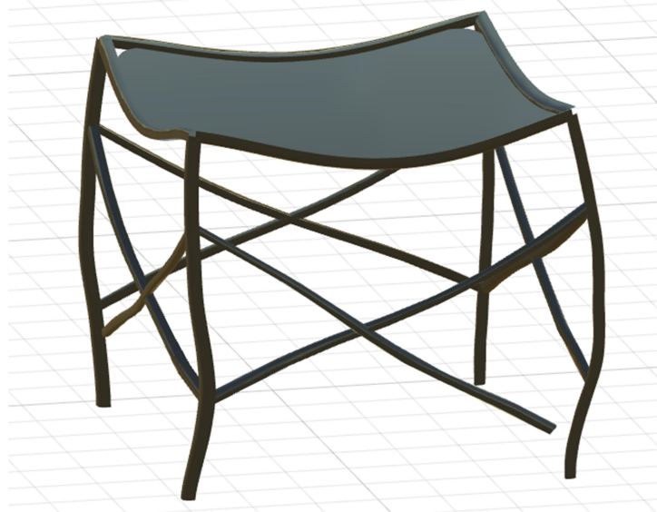
Figura 38 – Pórtico com perda accidental de travamentos
