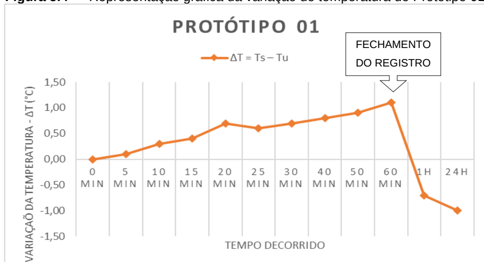
Figura 5.4 — Representação gráfica da variação de temperatura do Protótipo 01.
