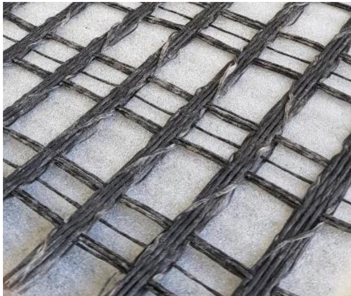
Figura 13: Detalhe da Geogrelha MacGrid WG90
