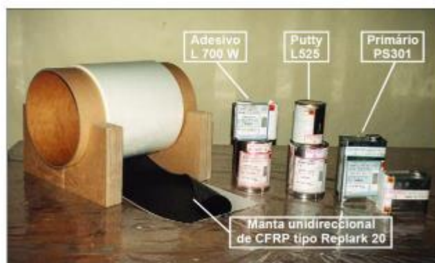
Figura 12 - Principais componentes do sistema curado in situ de PRFCs.
