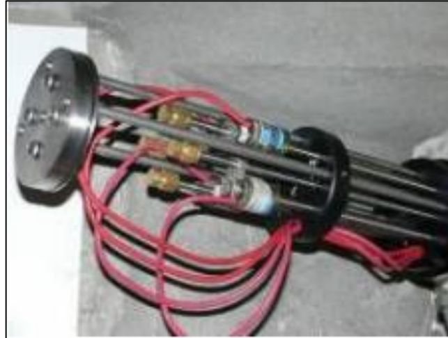
Figura 7 – Extensômetros de haste.
