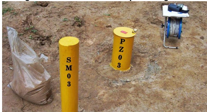
Figura 6 – Piezômetro do tipo Casagrande.
