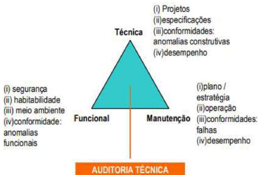
Figura 2 - Visão tríplice da inspeção predial.
