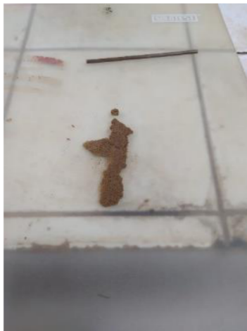
Foto 6 – Ensaio de Plasticidade
