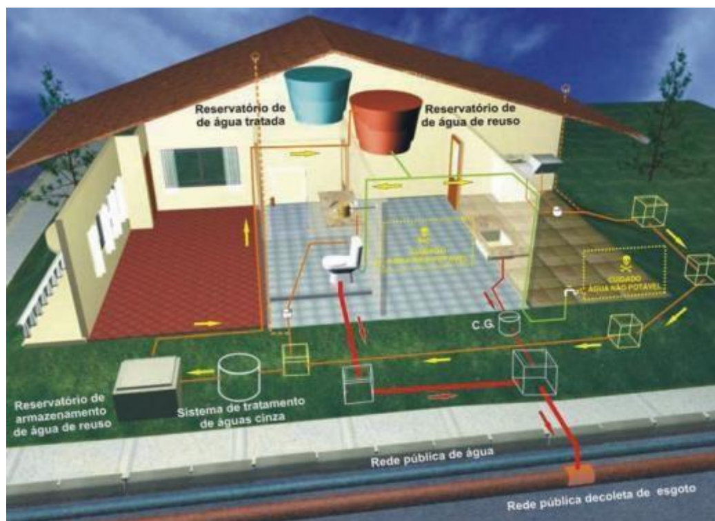
Figura 5: Esquema ilustrativo de um sistema de reuso de água
