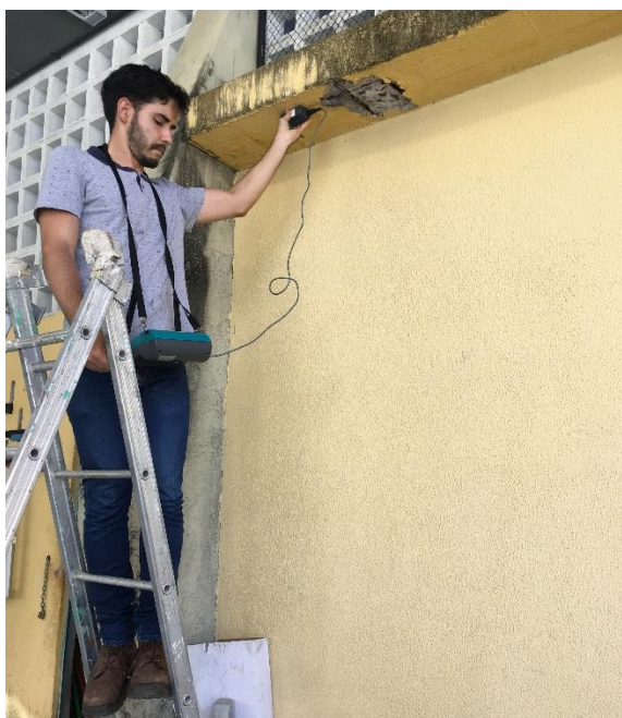
Figura 4.9 – Leitura do cobrimento com o pacômetro (a) e a área escarificada existente (b).
