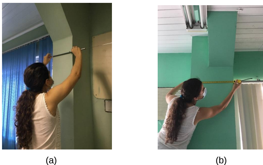
Figura 4.2 – Medição direta com o uso do paquímetro (a) e da trena (b).
