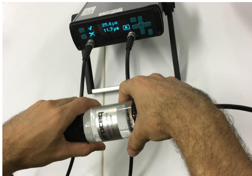
Figura 23 – Processo de calibração do equipamento Pundit Lab+ .
