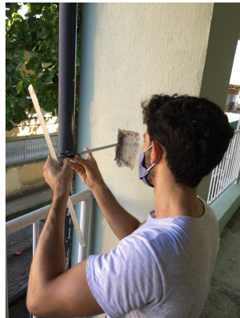
Figura 33 – Processo de escarificação (a) e medição com o paquímetro (b).
