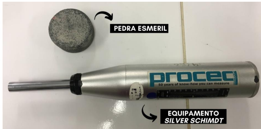
Figura 17 – Equipamento Silver Schmidt para ensaio de esclerometria.
