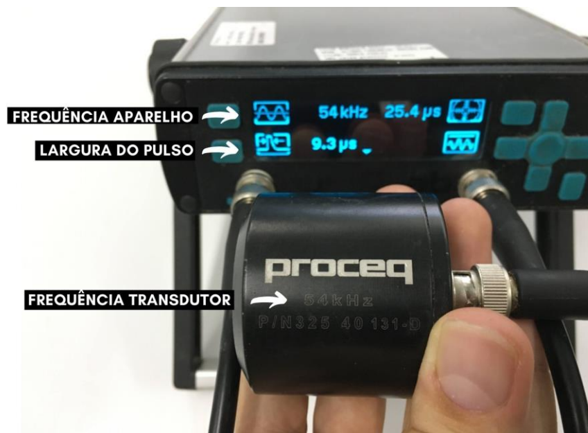
Figura 22 – Compatibilidade da frequência dos transdutores com o do aparelho Pundit Lab+ .
