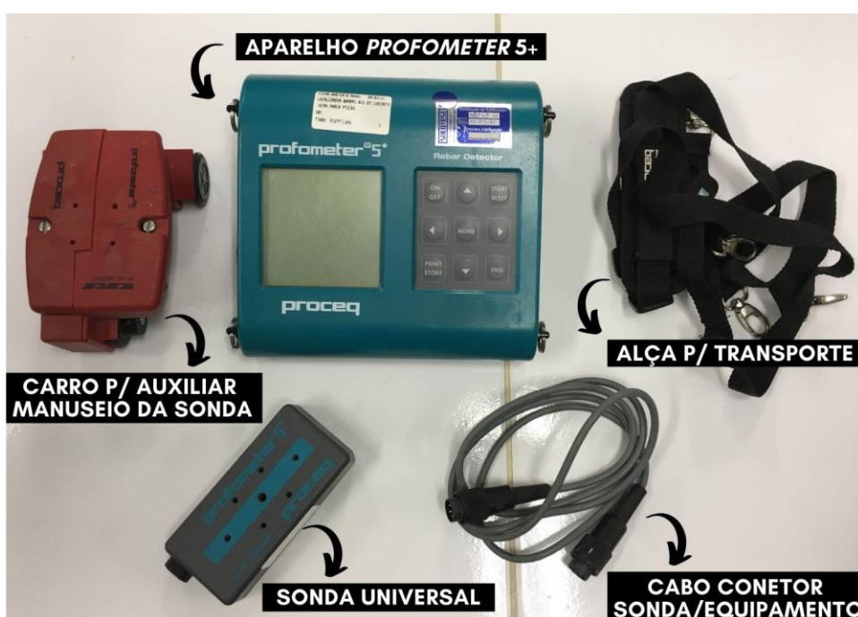
Figura 13 – Componentes do equipamento Profometer 5+ .
