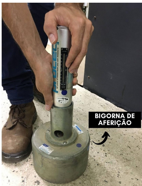
Figura 25 – Aferição do aparelho Silver Schmidt .
