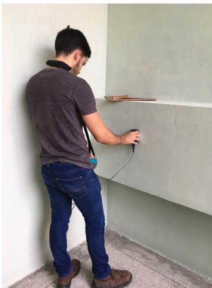
Figura 31 – Medição indireta com o pacômetro.
