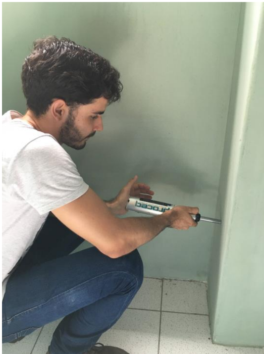
Figura 27 – Manuseio do Silver Schmidt durante o ensaio.
