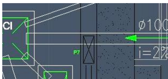
Figura 5 - P7 com tubulação sanitária
