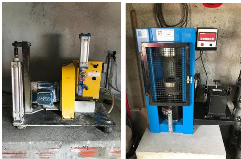
Figura 39 – Retífica faceadora e prensa hidráulica dos corpos de prova
