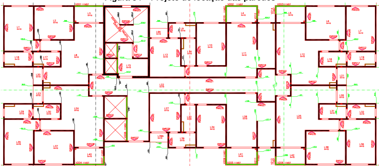
Figura 34 – Projeto de locação das paredes
