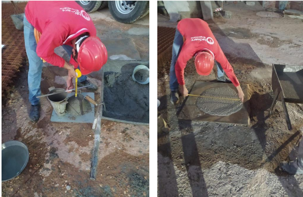
Figura 38 – Execução de Slump test e Slump flow
