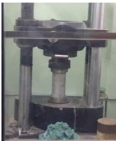
Figura 8 – Corpo de prova na prensa sendo rompido.
