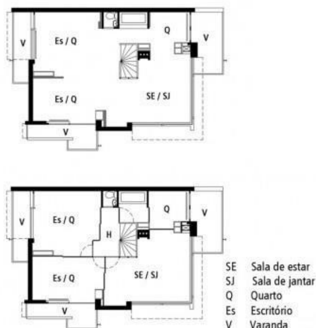
Figura 3 – Planta do pavimento superior da casa Schröder com painéis abertos (acima), dando a ideia um único cômodo, e fechados (abaixo), trazendo a ideia de vários ambientes.
