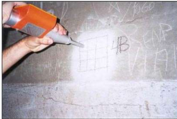
Figura 19 -Ensaio esclerométrico Fonte: Mitre (2005)
