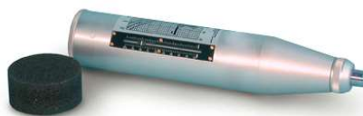
Figura 23 -Esclerômetro analógico schmidt – tipo N Fonte: Solotest (2021)
