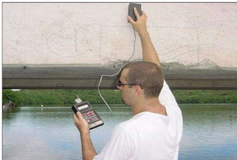
Figura 21 -Emprego de pacômetro em estrutura Fonte: Mitre (2005)
