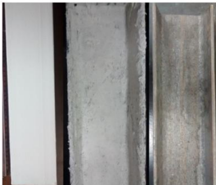
Figura 9 - Aparência dos corpos de prova após o preparo inicial e pintura intumescente.
