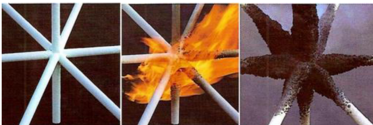
Figura 6 - Intumescimento de tinta na estrutura
