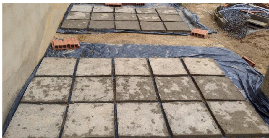
Figura 333 – Placas de argamassa de 0,40 m (comprimento) x 0,40 m (largura) x 0,03 m (espessura), após 14 dias Fonte: Autor (2021).
