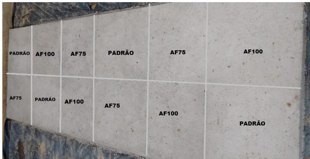
Figura 32 – Placas de argamassa de 2,40 m (comprimento) x 0,80 m (largura) x 0,03 m (espessura), após 14 dias Fonte: Autor (2021).
