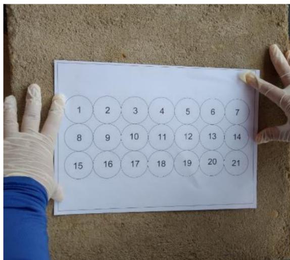
Figura 25 – Gabarito usado no ensaio de esclerometria Fonte: Autor (2021).
