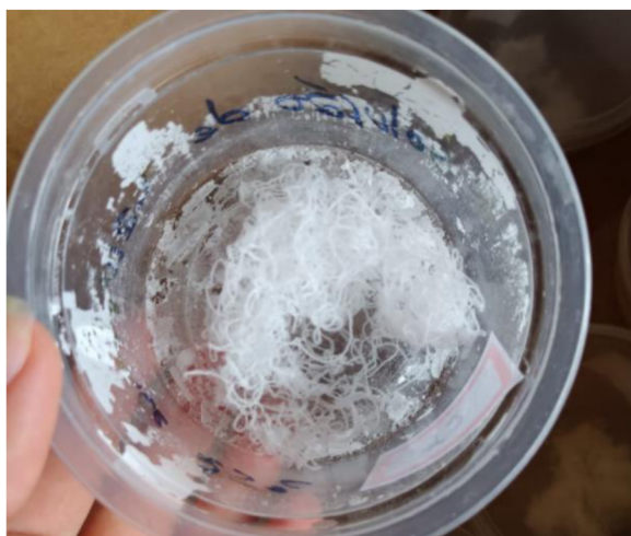
Figura 44 – Fibra a base de poliéster submetida a locução de Lawrence, por 8 meses Fonte: Autor (2021).
