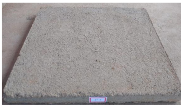
Figura 26 – Corpo de prova apoiado e pronto para o ensaio de esclerometria Fonte: Autor (2021).
