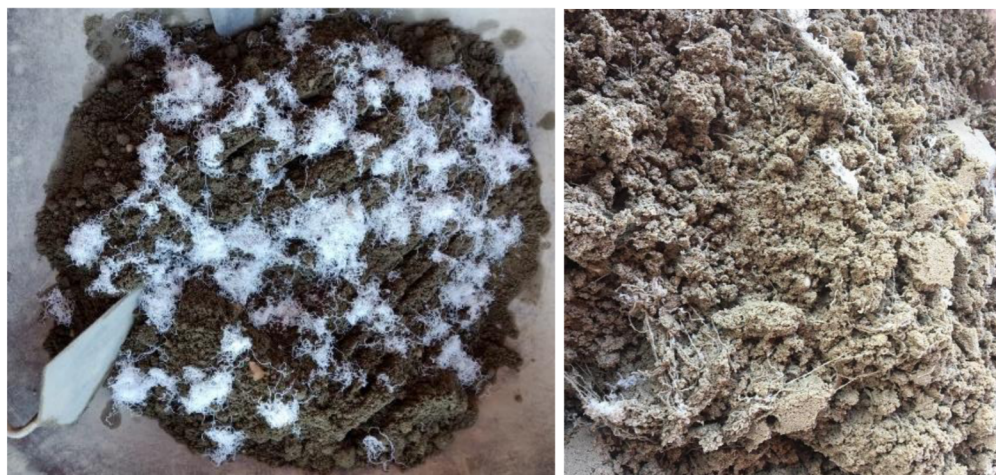
Figura 18 – Adição das fibras a base de poliéster na argamassa
