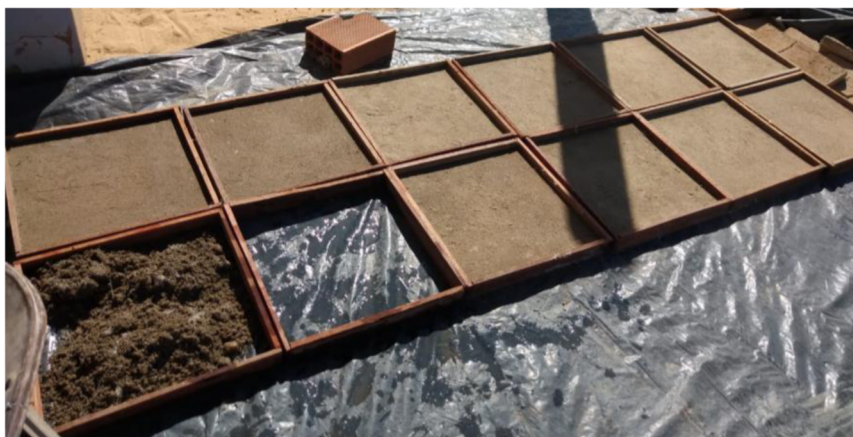
Figura 22 – Confeção dos corpos de prova para os ensaios de esclerometria e corpo duro
