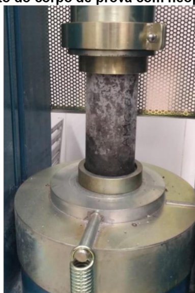
Figura 15 – Nivelamento do corpo de prova com neoprene para rompimento.
