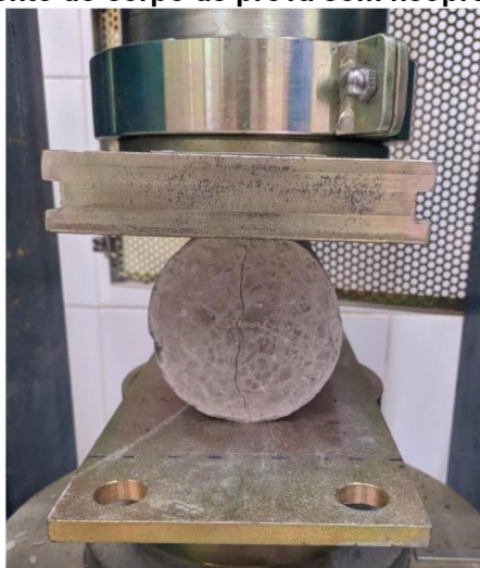
Figura 16 – Nivelamento do corpo de prova com neoprene para rompimento.
