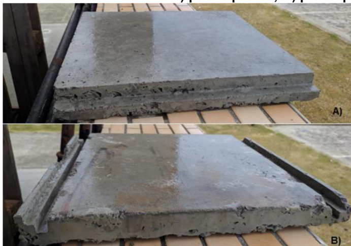
Figura 27 – Placa de concreto: A) protótipo “L”; B) protótipo “Z”.
