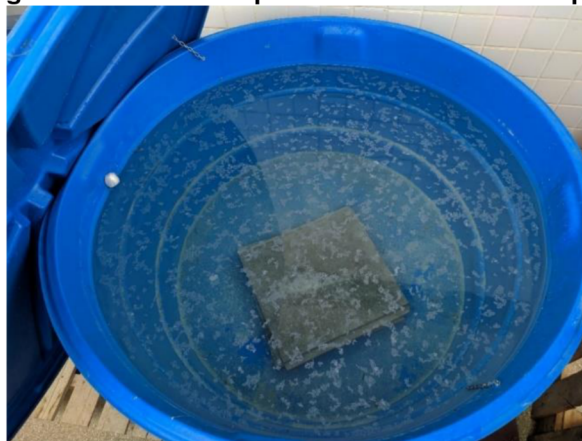
Figura 19 – Placa em processo de cura no tanque.
