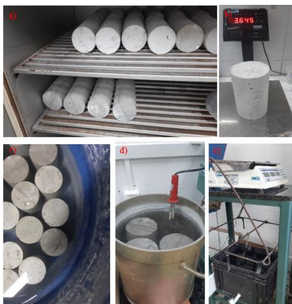
Figura 6 – Etapas do ensaio de absorção de água, índice de vazios e massa específica real, a) Amostras em estufa; b) Determinação da massa seca em estufa; c) Amostras submersas em água; d) Processo de ebulição da água com as amostras; e) Determinação da massa da amostra saturada imersa em água, após fervura (O autor, 2022).
