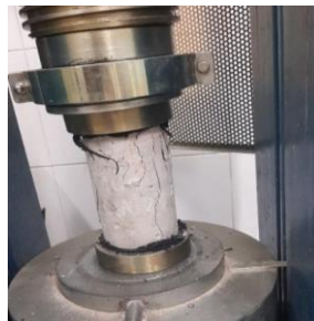
Figura 7 – Ensaio de resistência à compressão com a prensa hidráulica, após rompimento da amostra (O autor, 2022).
