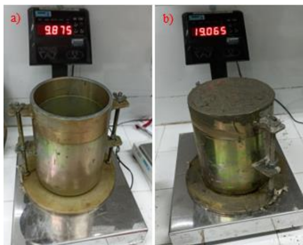
Figura 5 – Ensaio pelo método gravimétrico, a) Determinação da massa do recipiente; b) Determinação da massa do recipiente com o concreto (O autor, 2022).
