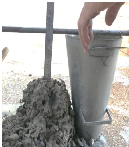
Figura 4 – Medição do índice de consistência (O autor, 2022).
