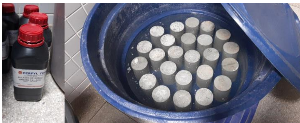
Figura 8 – Ensaio de durabilidade com amostras em solução de sulfato de sódio (O autor, 2022).
