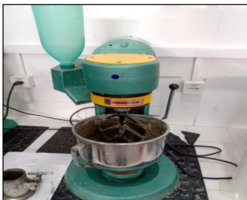
Figura 12 – Homogeneização da argamassa, (Própria autoria, 2021).
