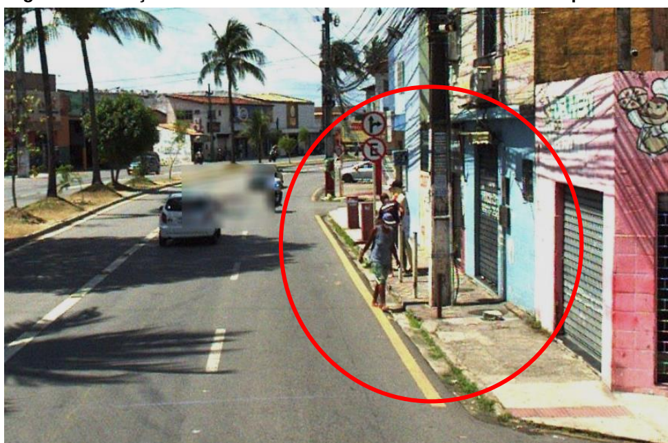
Figura 65 – Calçada Estreita e com Mobiliário Dificultando o uso pelos Pedestres
