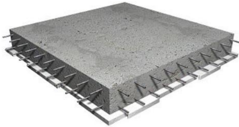
Figura 1 - Modelo de laje maciça.
