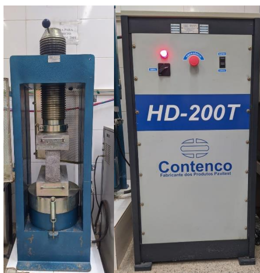
Figura 8 - Prensa Pavitest com bloco posicionado (O autor, 2022).
