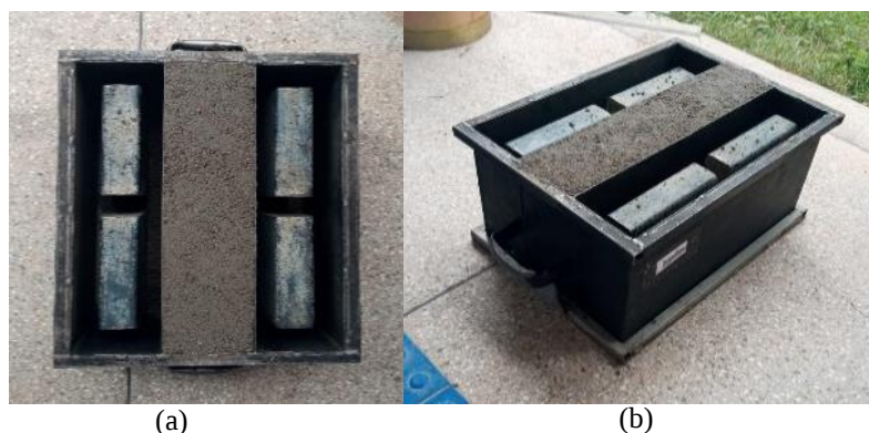
Figura 3 (a) e (b) - Moldagem do bloco de concreto (O autor, 2022)
