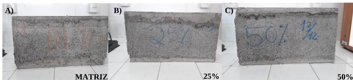
Figura 9 - Rompimento dos blocos: (a) Bloco referência; b) 25% de argila expandida e c) 50% de argila expandida (O autor, 2022)
