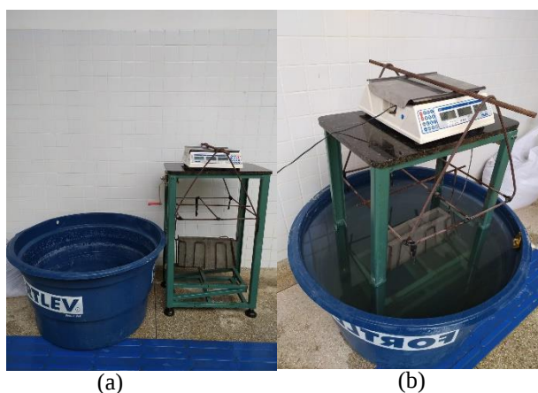
Figura 6 - Determinação da massa imersa: (a) Adaptação da aparelhagem e (b) Amostra imersa (O autor, 2022).
