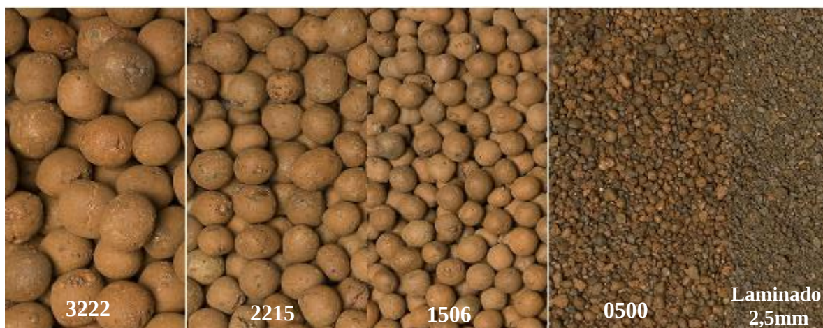
Figura 1 - Granulometria das argilas expandidas (Cinexpan, 2021).
