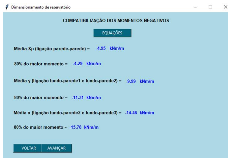
Figura 21 – Interface com resultados da compatibilização dos momentos (Fonte: AUTORA, 2022)
