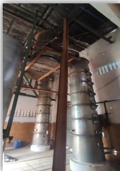
Figura 28- Processo de Cachaça destilada do Alambique do Povoado Pirunga
