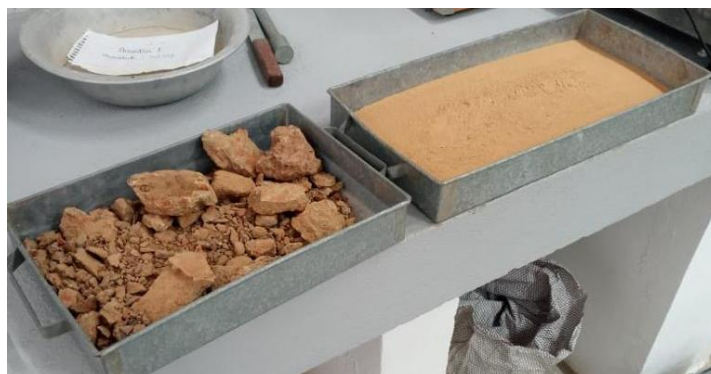
Figura 3 - Solo em torrões e solo após a moagem (O autor, 2021)
