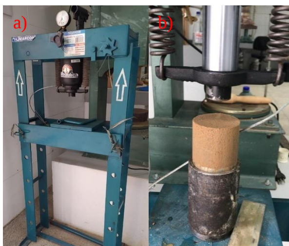
Figura 5 - Prensagem, a) Modelo da prensa; b) Tijolo prensado (O autor, 2021).
