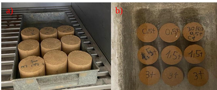
Figura 7 - Ensaio de absorção de água a) Tijolos em estufa; b) Tijolos imersos em água (O autor, 2021).
