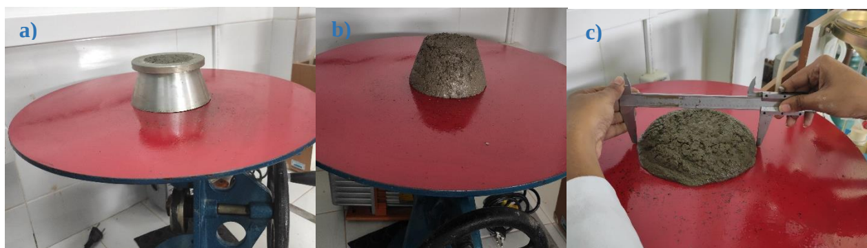
Figura 7 – Etapas do ensaio de índice de consistência, a) Mesa de consistência e tronco de cone; b) Argamassa antes de ser submetida aos 30 golpes; c) Medição do espalhamento da argamassa (O autor, 2021).
