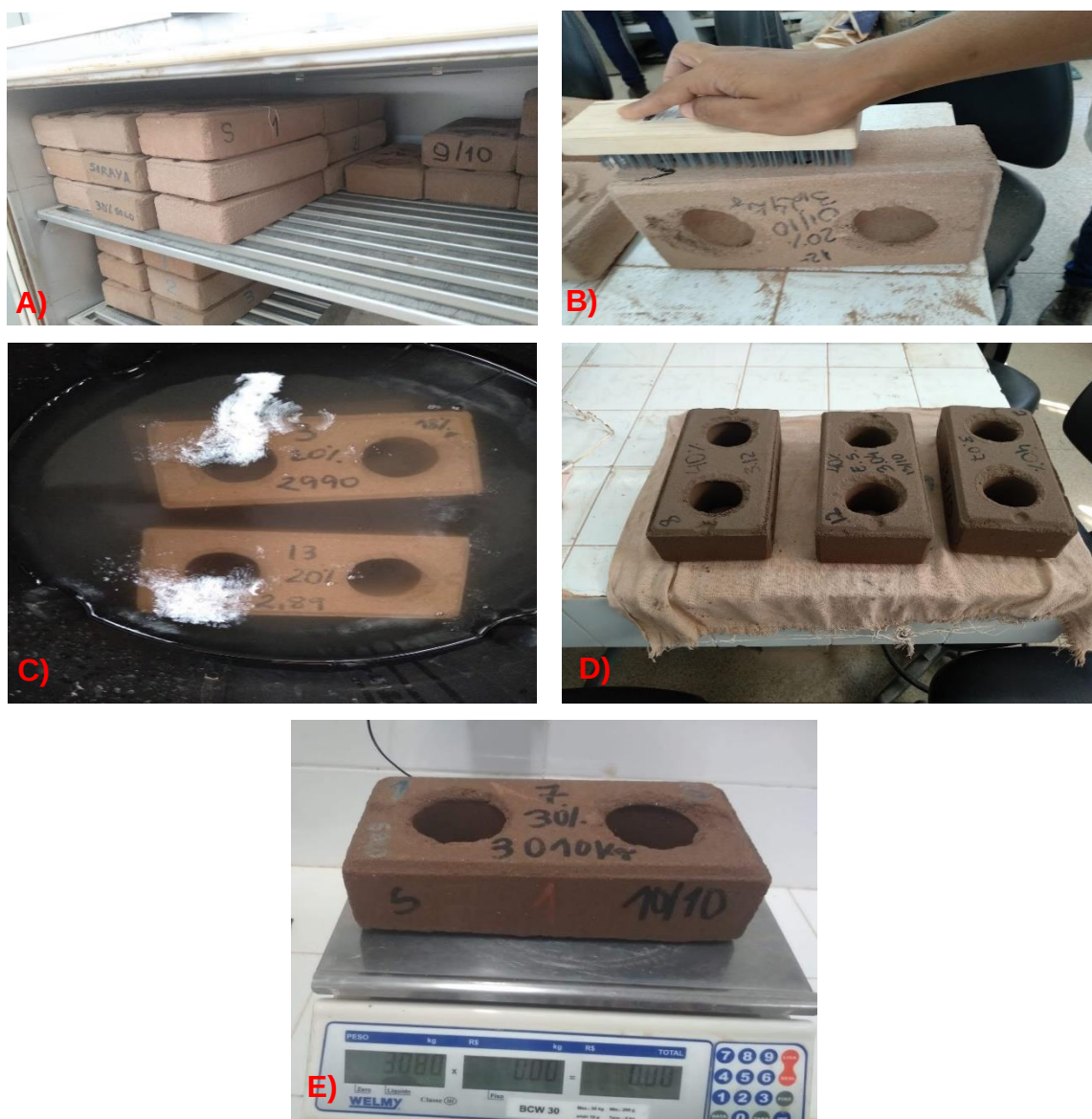
Figura 21 – Etapas realizadas para ensaio de resistência de durabilidade, A) Tijolos postos na estufa; B) Escovação dos tijolos 2 e 3; C) Tijolos na água; D) Tijolos retirados da água para secagem; E) Pesagem depois de úmido
