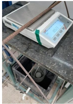
Figura 17 - Obtenção da massa do corpo de prova submerso (O autor, 2022).
