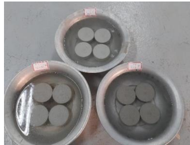
Figura 19 - Corpos de prova imersos em água (O autor, 2022).
