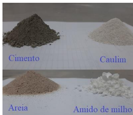
Figura 13 - Materiais utilizados na produção dos corpos de prova (O autor, 2022).
