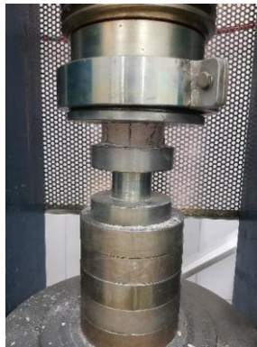
Figura 18 - Rompimento do corpo de prova (O autor, 2022).
