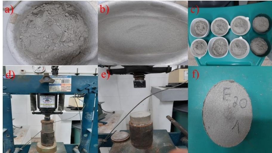
Figura 15 - Produção dos corpos de prova.
