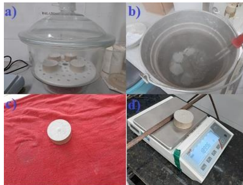
Figura 16 - Etapas do ensaio de absorção de água.
