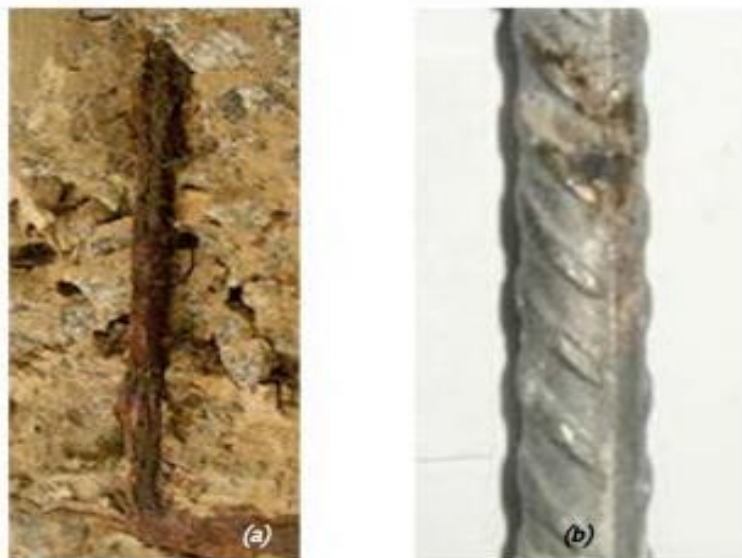
Figura 5 – Aparência superficial da corrosão generalizada desencadeada pela carbonatação do concreto (a) e da corrosão puntiforme desencadeada pela ação dos íons cloreto (b)
