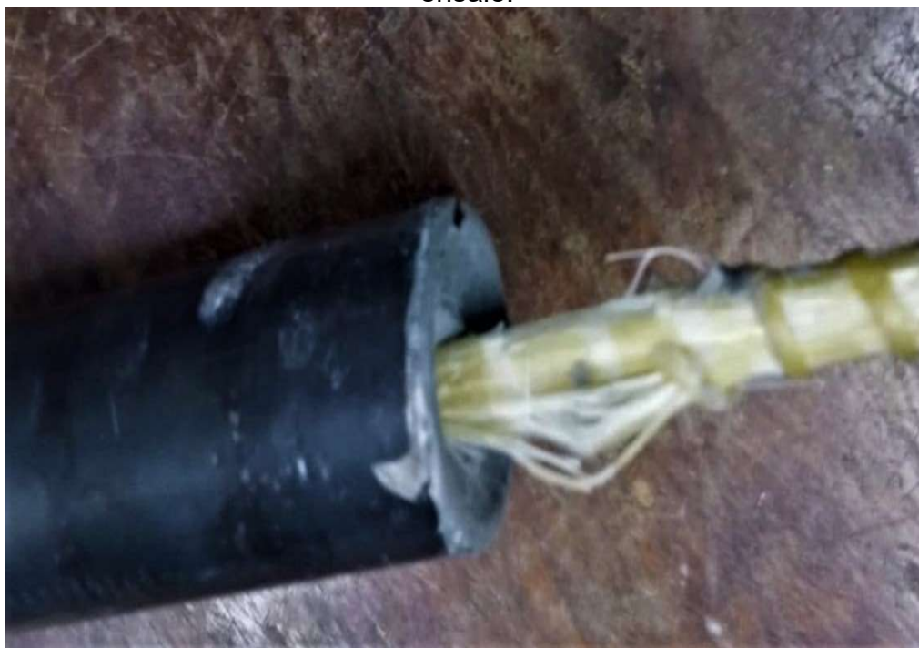
Figura 19: Corpo de prova com rompimento na extremidade da barra durante o ensaio.
