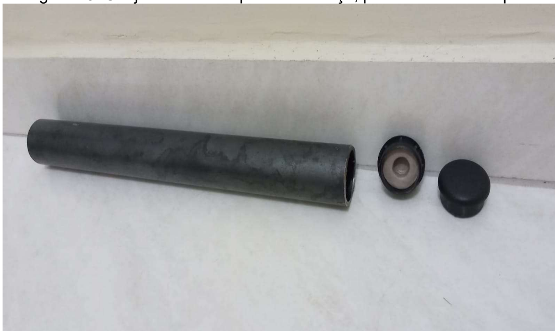
Figura 15: Conjunto formado por tubo de aço, ponteira e massa epóxi.
