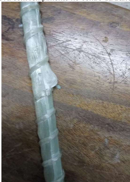
Figura 21: Corpo de prova com rompimento no centro da barra durante o ensaio.
