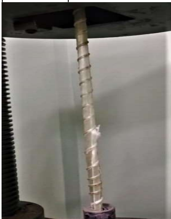
Figura 20: Corpo de prova com rompimento no centro da barra durante o ensaio.
