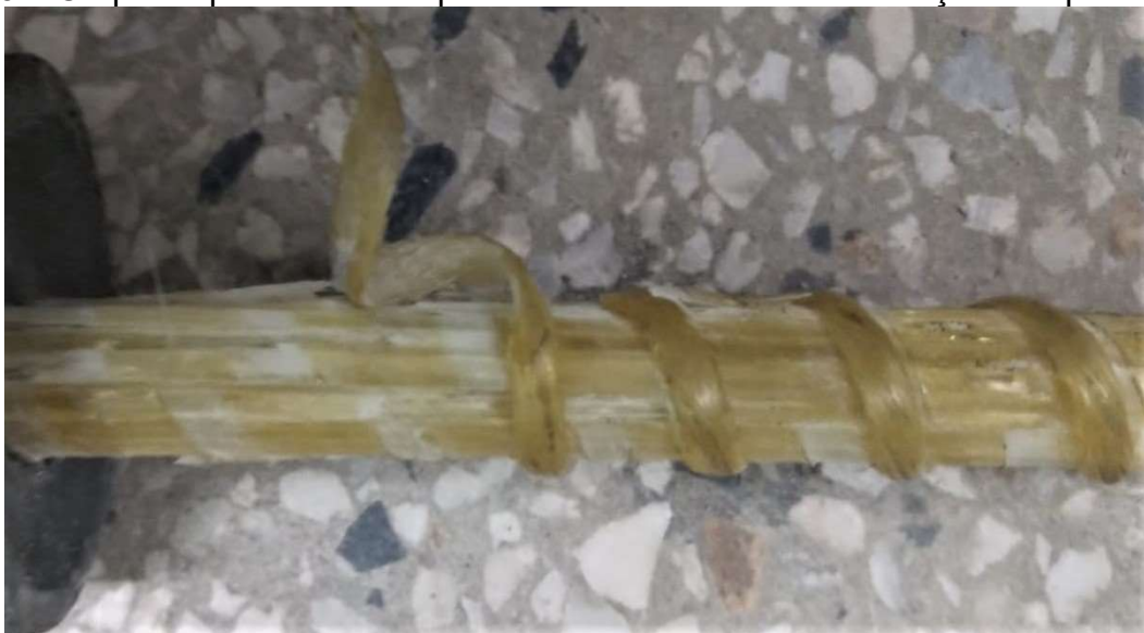
Figura 34: Corpo de prova com desprendimento da nervura em relação a superfície.
