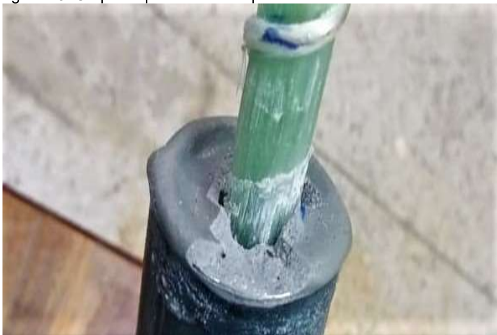
Figura 18: Corpo de prova com rompimento na resina durante o ensaio.
