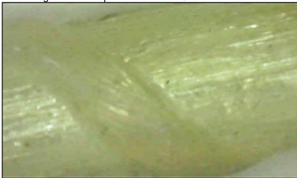
Figura 24: Imagem microscópica da barra de 10 mm antes da imersão alcalina.
