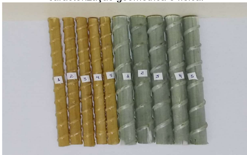
Figura 11: Conjuntos de barras GFRP com 10mm e 12,5 mm de diâmetro para caracterização geométrica e física.
