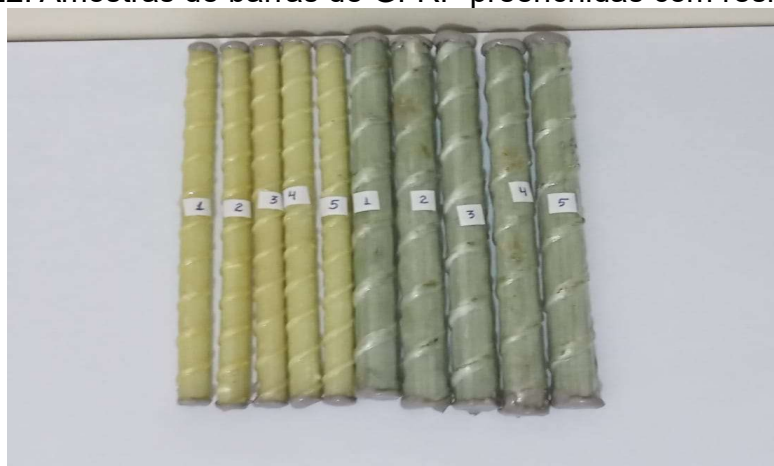
Figura 22: Amostras de barras de GFRP preenchidas com resina epóxi.
