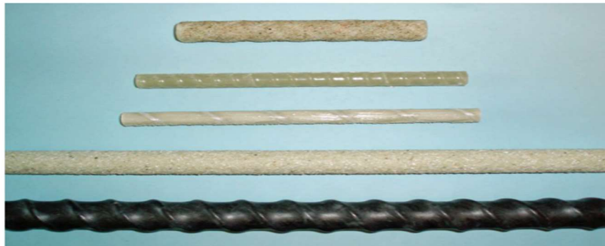
Figura 4: Exemplos de barras de FRP de acordo com o acabamento superficial.
