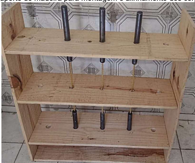
Figura 16: Suporte de madeira para montagem e alinhamento dos corpos de prova.
