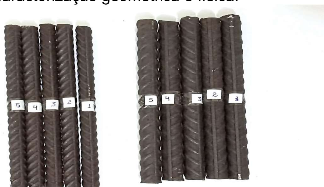
Figura 12: Conjuntos de barras de aço com 10mm e 12,5 mm de diâmetro para caracterização geométrica e física.
