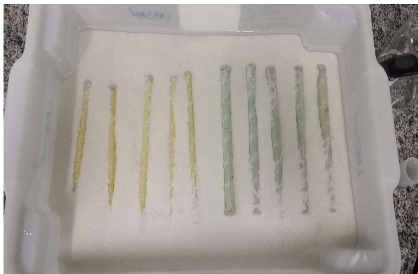
Figura 23: Barras de GFRP imersas na solução alcalina.
