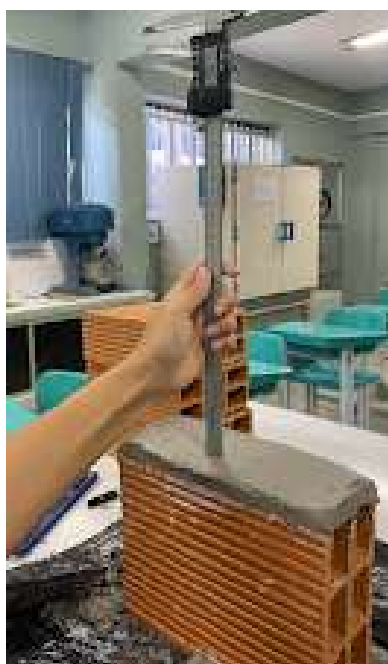
Imagem 14 - Verificação da espessura da junta de assentamento
