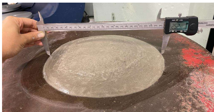
Imagem 10 - Obtenção de índice de consistência conforme NBR 13276 (2016)
