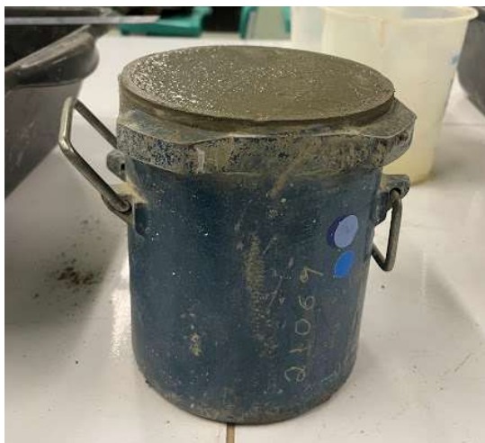
Imagem 7 - Recipiente preenchido com argamassa e rasado
