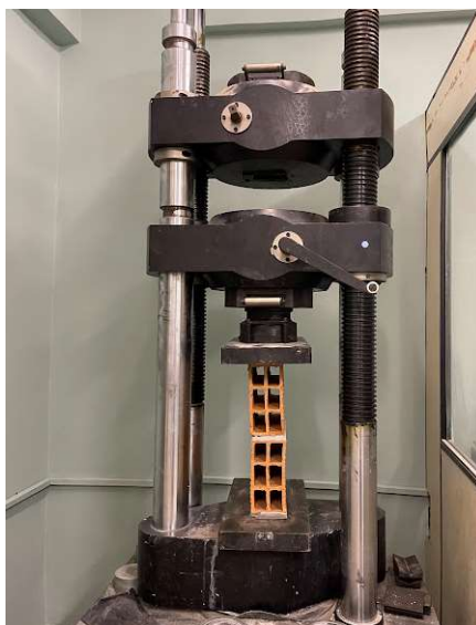
Imagem 17 - Prisma de bloco cerâmico preparado para início do ensaio de compressão
