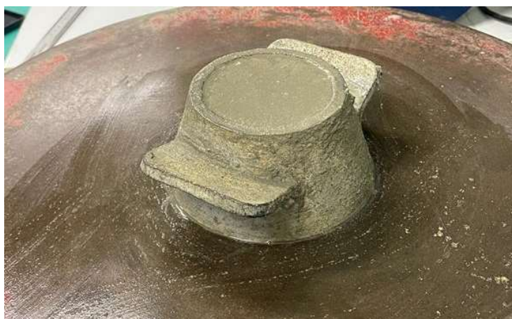
Imagem 9 - Argamassa moldada no molde troncônico
