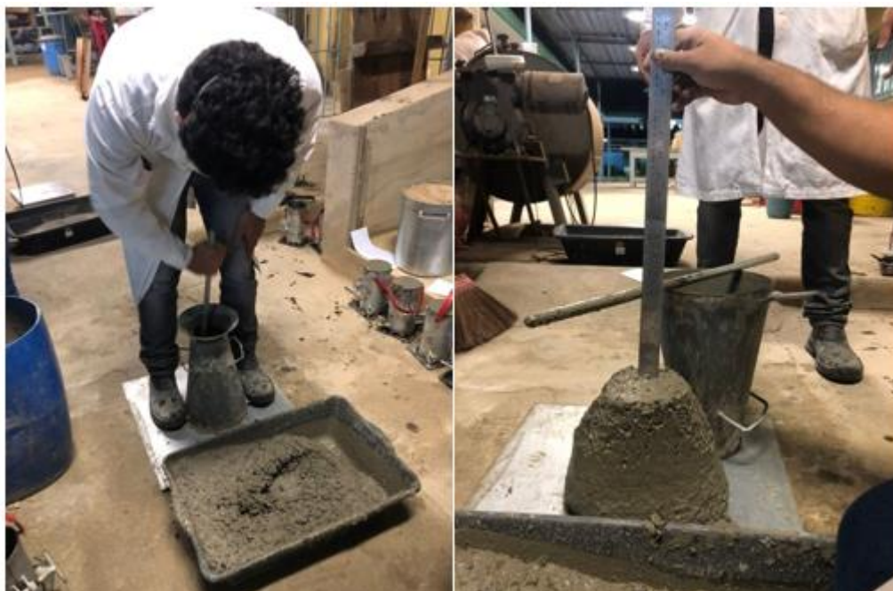
Figura 27 – Execução de ensaio Slump Test .
