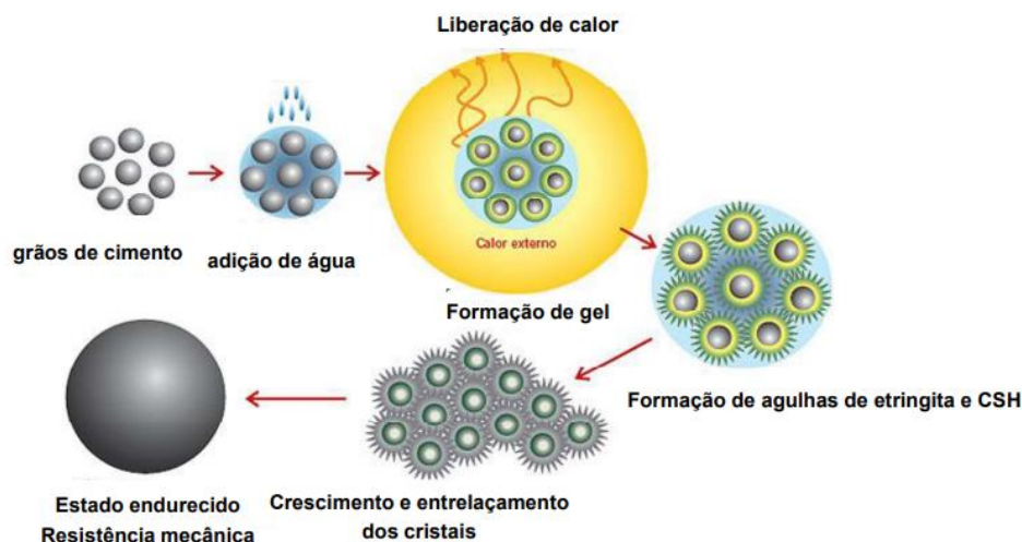
Figura 14 – Esquema de hidratação e pega do cimento Portland.
