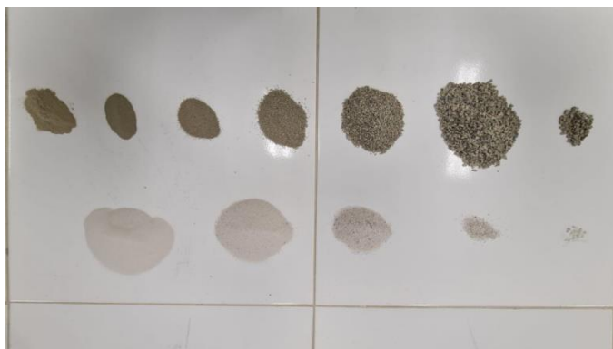
Figura 22 – Areia natural e artificial para caracterização.
