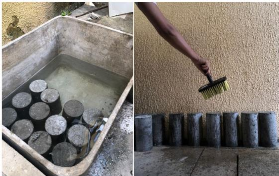
Figura 28 – Corpos de prova sendo curados nos dois ambientes de cura (por imersão e molhagem contínua).
