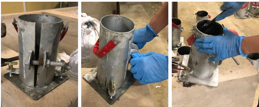
Figura 17 – Travamento e aplicação de desmoldante nos corpos cilíndricos de dimensões 100 mmx200 mm.
