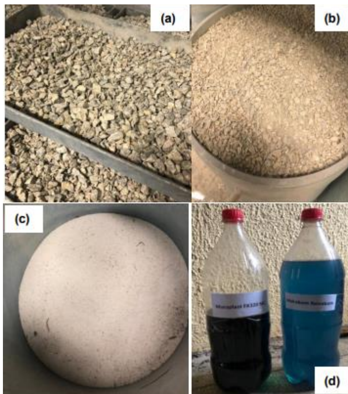
Figura 14 - Materiais utilizados na produção dos concretos: (a) brita; (b) areia artificial; (c) areia natural e (d) aditivos.
