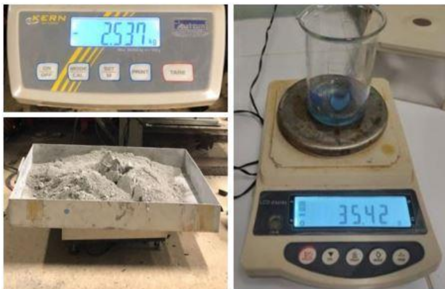
Figura 16 - Pesagem do cimento Portland e do aditivo.
