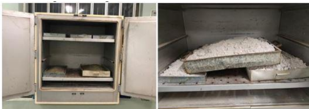
Figura 15 - Secagem das areias artificial e natural em estufa.
