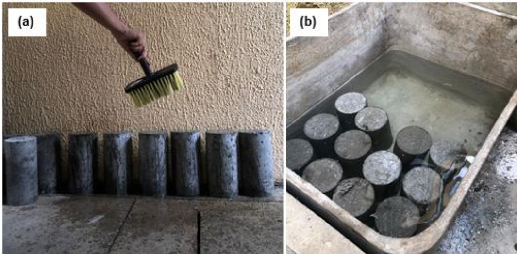
Figura 22 - (a) Cura por Molhagem Constante; (b) Cura por Imersão.
