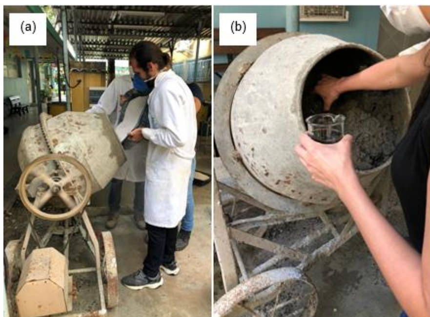
Figura 18 - Colocação dos insumos na betoneira: (a) Colocação da areia natural; (b) Colocação dos aditivos.
