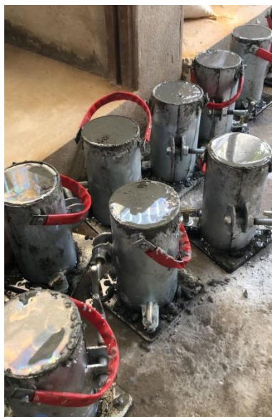
Figura 21 - Proteção da superfície dos CPs com lâmina d'água.
