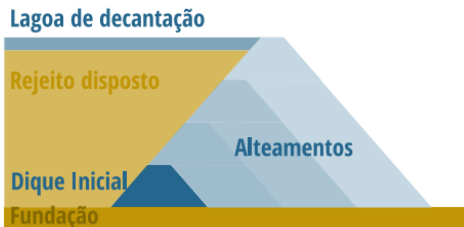
Figura 13 - Corte esquemático do método de alteamento à jusante
