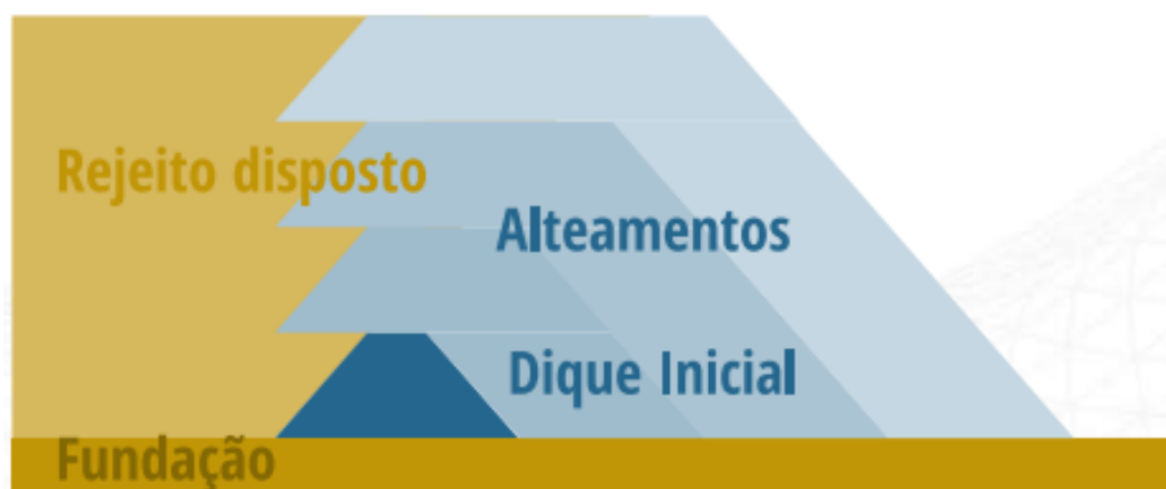
Figura 15 - Corte esquemático do método de alteamento de linha de centro
