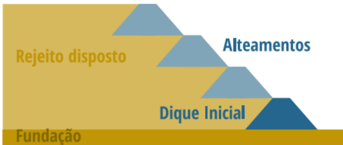
Figura 14 - Corte esquemático do método de alteamento à montante
