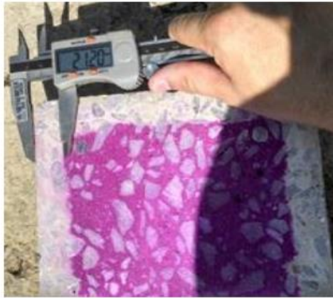
Figura 12 - Dimensão da frente de carbonatação Fonte: Pires (2016)
