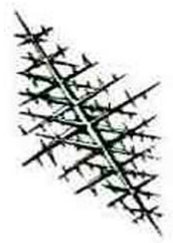
Figura 2: Esquema estrutural de uma dendrita (Fonte: FERRAZ, 2003)
