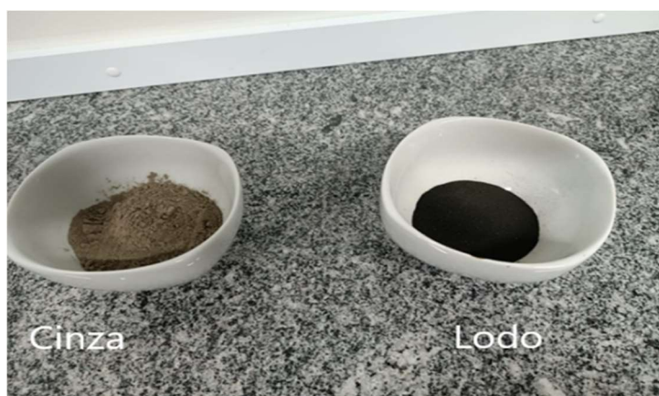
Figura 11 - Resíduos antes da mufla (O Autor, 2022)
