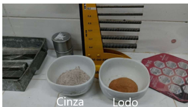
Figura 12 - Resíduos após a mufla (O Autor, 2022)
