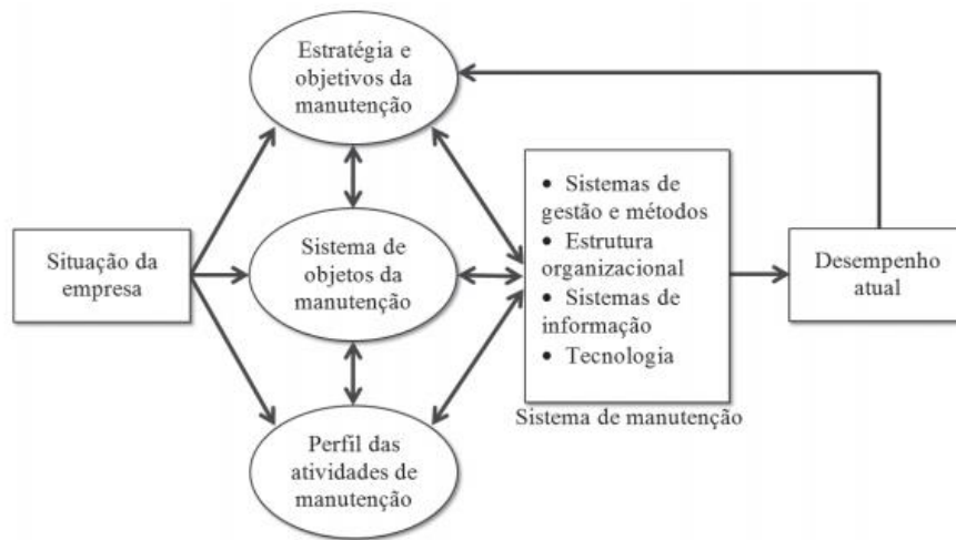
Figura 4: Modelo conceitual do sistema de manutenção industrial proposto por Riis et al. (1997)
