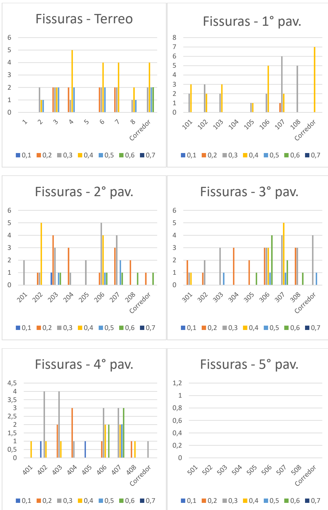
Gráfico 4 - Espessuras e quantificação das fissuras presentes nos pavimentos.
